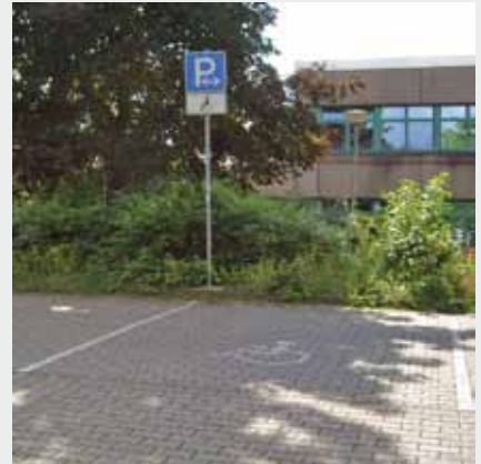
Bei diesem Behindertenparkplatz ist der gefahrlose Ausstieg beidseitig möglich
