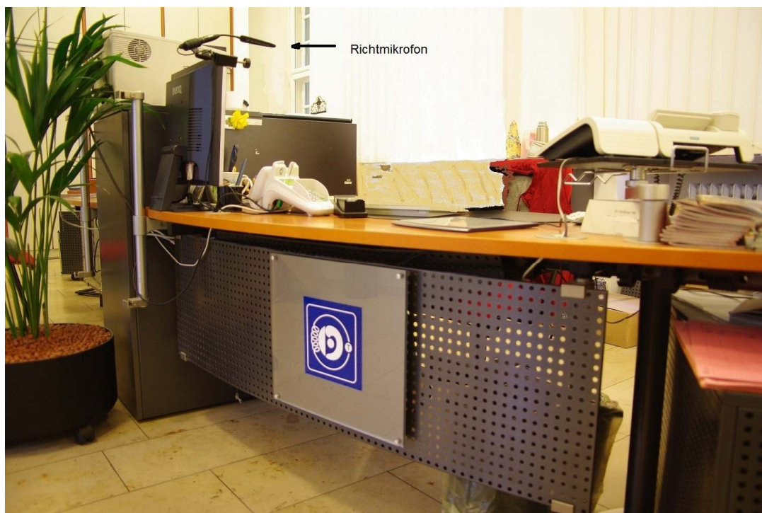
Abbildung 8 : Praktischer Aufbau eines lokalen Systems mit Richtmikrofon- Kundenseite
