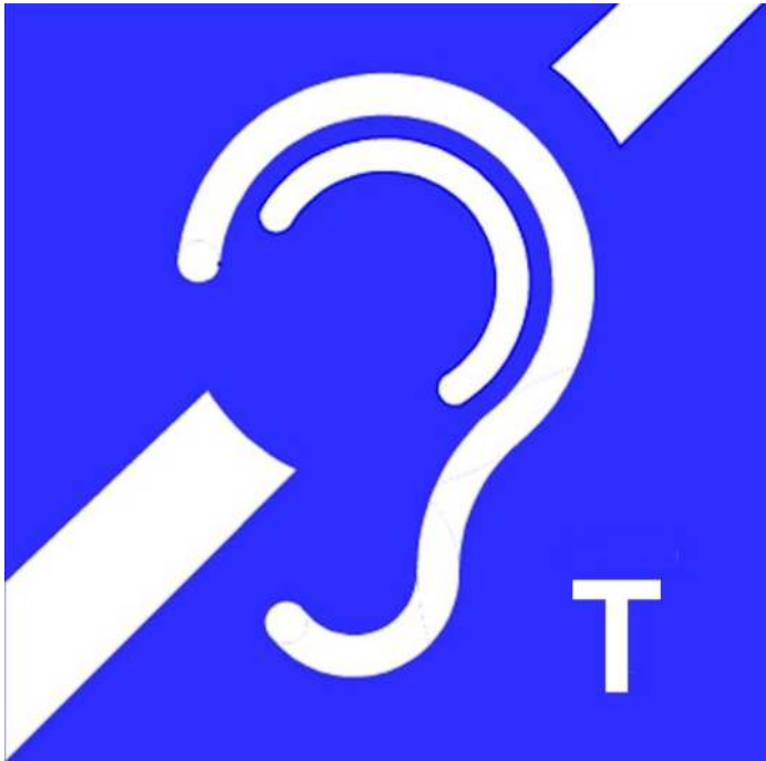
Abbildung 16 : Piktogramm für induktive Höranlagen gemäß DIN EN 60118-4
